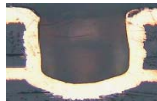
Schliffbild eines Blind Vias
